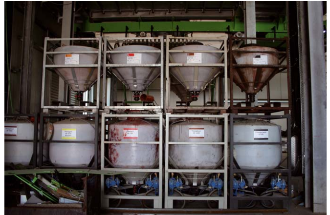
Die individuelle Farbgestaltung erfolgt mit der Farbdosierung für 4 Farben.
