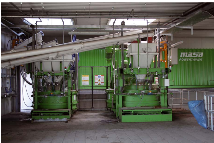
Zwei Horizontal-Zwangsmischer von Masa produzieren Vorsatz- und Kernbeton für die Steinfertigung (im Bild mit einem Masa Powertainer).
