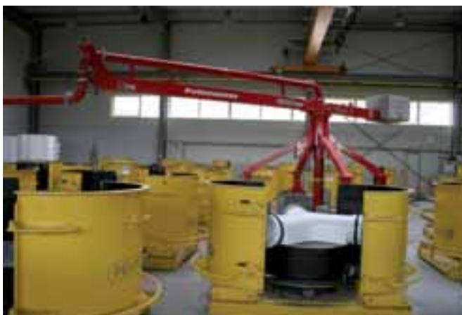
Model kinety kładzie się na pokrywą rdzenia i zamyka formę. Formy zalewane są betonem dostarczany przy pomocy stacjonarnej pompy Putzmeister.
