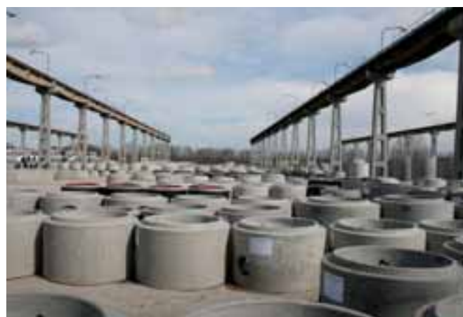
Jednym z ważniejszych produktów firmy Betonika plus s.r.o. są monolityczne dna studni wykonywane w technologii Perfect jako jeden monolityczny odlew.
