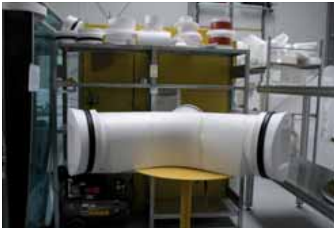
Gotowy model kinety z założonymi uszczelkami zintegrowanymi.
