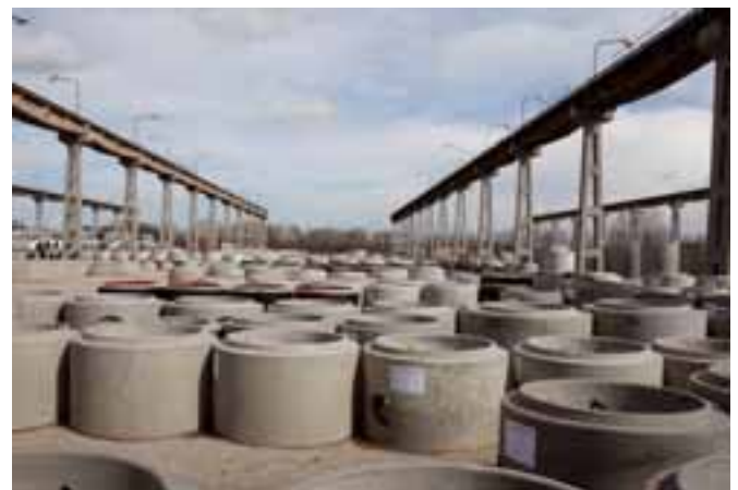
)) Uno dei punti focali della produzione di Betonika plus s.r.o. è la fabbricazione di fondi per pozzetti, che con il nuovo sistema Perfect possono essere realizzati in versione monolitica, in un unico getto.
