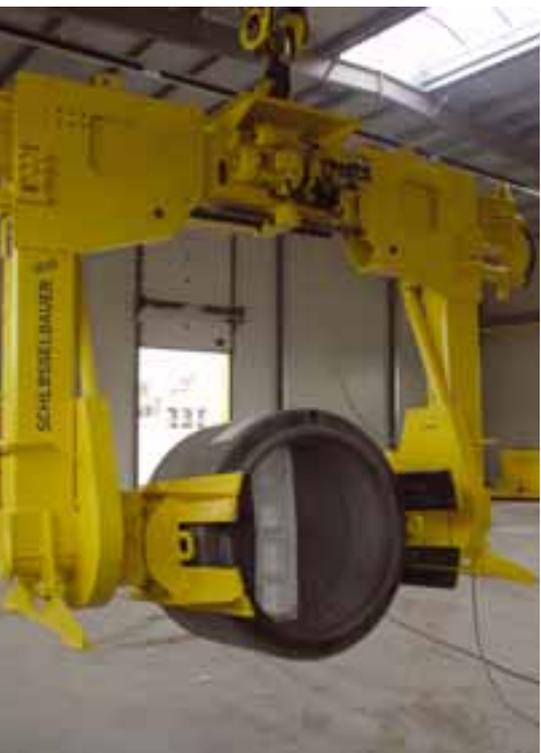
Die ausgehärteten Schachtunterteile werden mittels des Schlüsselbauer-Wendegerätes entschalt und gewendet
