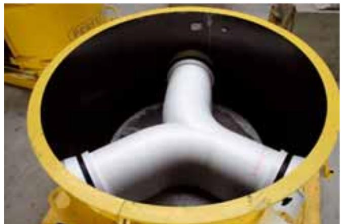
*Der vorbereitete Aussparungskörper wird auf den Innenkern aufgesetzt und die Schalung anschließend geschlossen, die Betonage erfolgt dann mit Hilfe der stationären Putzmeister-Betonpumpe*
