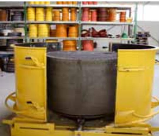
nommen werden. Der folgende Abtransport der fertigen Schachtunterteile aus der Halle erfolgt mit dem Transportband. Im Außenbereich werden die Schachtunterteile dann mit dem Gabelstapler ins Außenlager gebracht oder gleich zur Auslieferung auf einen LKW geladen.
