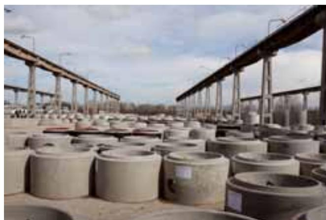
Einer der Produktionsschwerpunkte bei Betonika plus s.r.o. ist die Fertigung von Schachtunterteilen, die mit dem neuen Perfect-System monolithisch in einem Guss hergestellt werden können.
