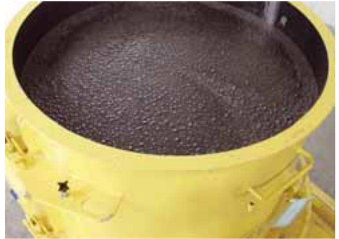
Hergestellt werden die Schachtunterteile aus selbstverdichtendem Beton, der mit der Putzmeister-Pumpe zu den einzelnen Schalungen gepumpt wird
