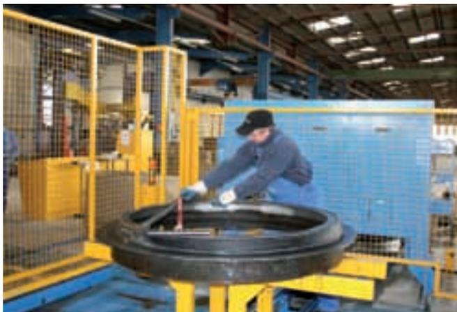
Насаживание изоляции на продукты с интегрированной изоляцией.
