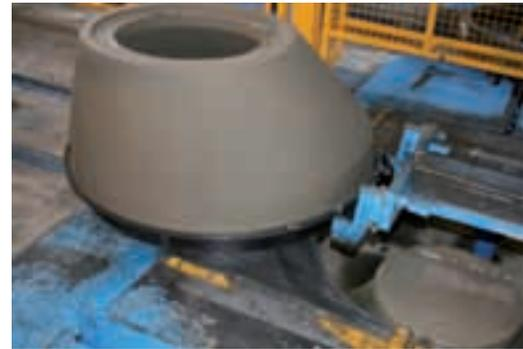
Производственный процесс: вставляется муфта; форма заполняется бетоном; после уплотнения шахтный конус очищается и выдвигается из установки.
