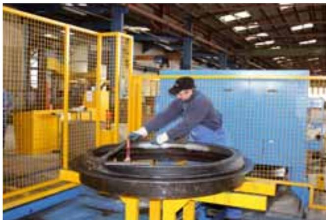
Mise en place du joint pour des produits avec joint intégré
