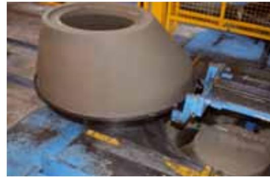
*Déroulement de la production : introduction de l'embase, remplissage du moule, démoulage de la tête réductrice après compression et finalement évacuation hors de l'installation*
