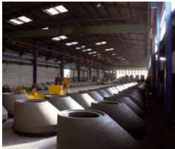
*Produit frais dans la «zone de parking» et avant le transport sur le parc de séchage*
