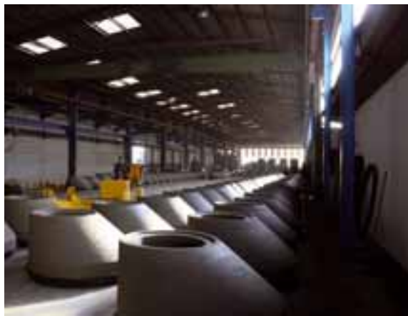
Feuchtes Produkt in der „Parkzone“ und vor dem Transport in den Trocknungsbereich
