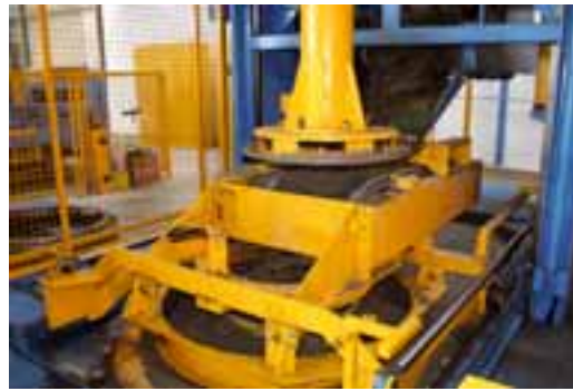
Produktionsablauf: Muffe wird eingeschoben, Beton wird in die Form gefüllt, nach der Verdichtung wird der Schachtkonus entschalt und aus der Anlage geschoben
