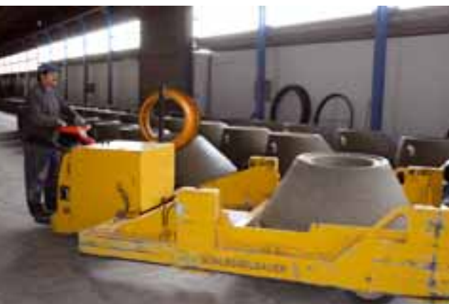
Transport der Produkte, Entmuffung in der Palettieranlage, Abtransport zum Außenlager
