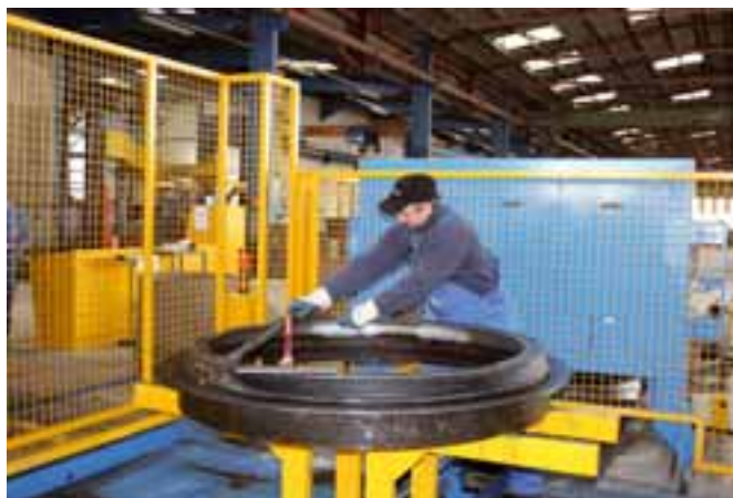
Aufziehen der Dichtung für Produkte mit integrierter Dichtung
