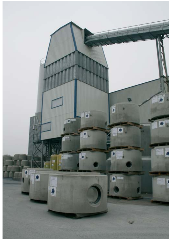
Każda hala w firmie Plattard posiada własny węzeł betoniarski. Pozwala to na niezależną produkcję.
