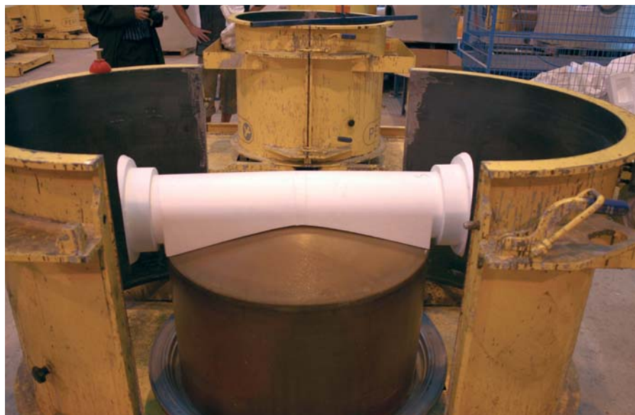
Gotowe modele kinety wkładane są do specjalnych form.
