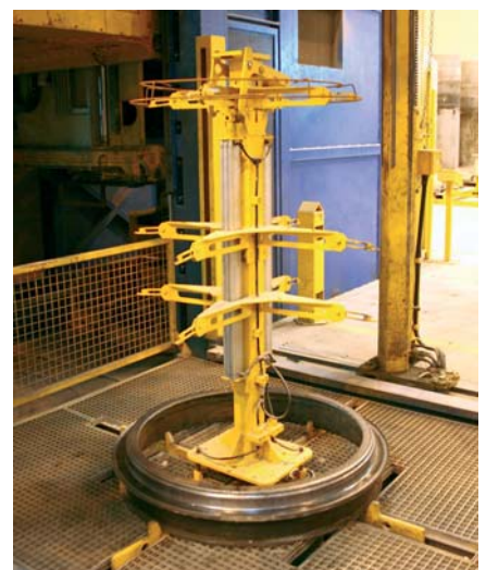
Przed rozpoczęciem produkcji kręgów pozycja pierścienia dolnego, pierścienia zbrojeniowego, szczelbi włazowych i kotw transportowych ustalana jest automatycznie.
