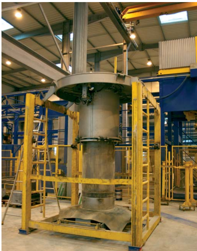
Formy do wymiany przygotowuje się na poziomie posadzki w specjalnych kasetach.
