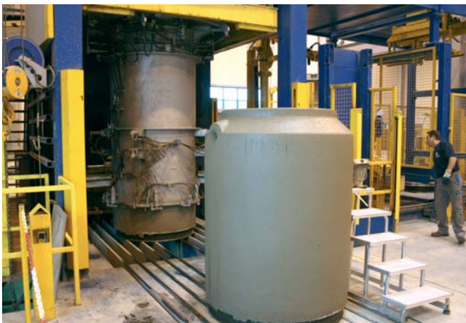
Elementy studni rozformowywane są bezpośrednio w maszynie.
