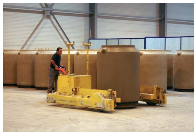
Wyroby odwozi się na miejsce dojrzewania specjalnym wózkiem elektrycznym...
