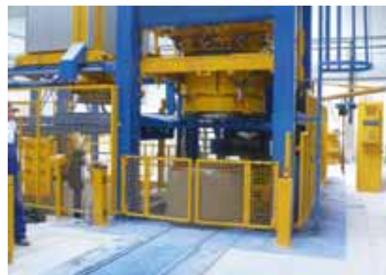
Il sistema Exact 1500 in funzione: fabbricazione completamente automatica di anelli con fondelli superiori ed inferiori
