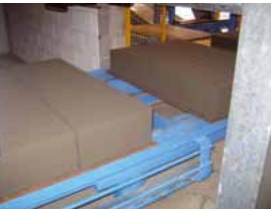
Produzione di 24 blocchi (440mm x 215 mm x 100 mm)
