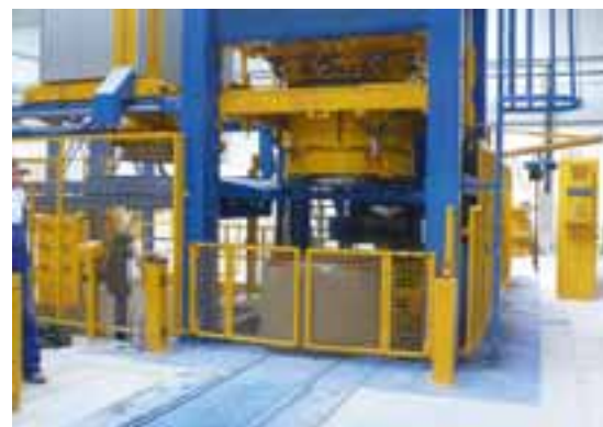
Exact 1500 en marche – production entièrement automatisée d'éléments de regards sur embases et avec rondelles supérieures
