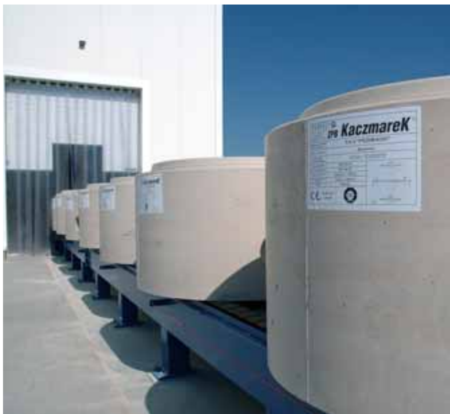
Le marquage de chaque fond de regard sur-mesure est à la base de la logistique – jusqu'à la mise en place sur le chantier
