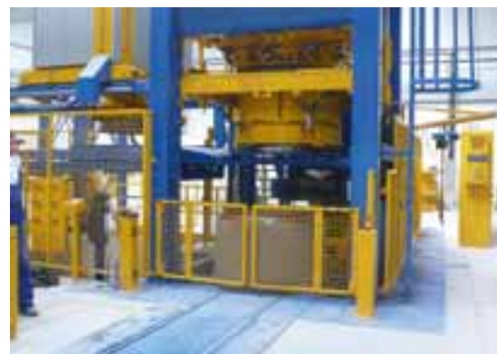
Die Exact 1500 im Einsatz – vollautomatische Fertigung von Schachtringen mit Ober- und Untermuffen
