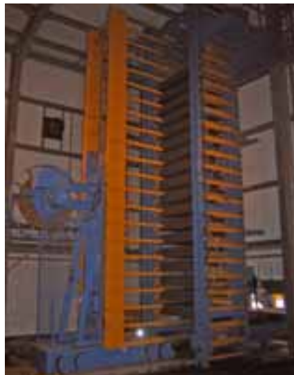
Die Schiebebühne nimmt die Stahlpaletten mit Produkten auf
