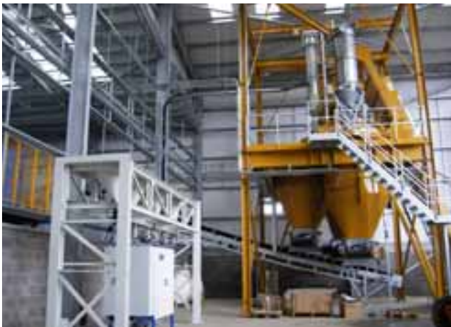
Der 4.500-Liter-Mischer von Haarup produziert alle 3 Minuten 7 Tonnen Material. Links: Die 4-Farben-Granulat-Dosieranlage von Würschum
