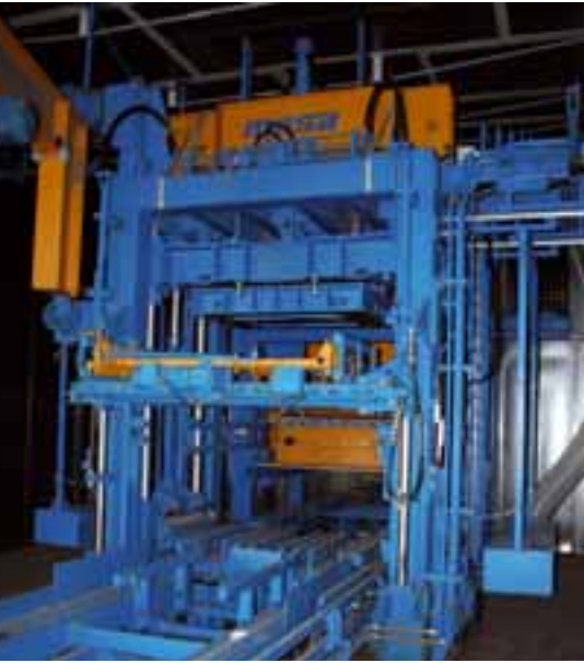
Herzstück der neuen Cemex-Anlage ist eine Masa XL 9.1
