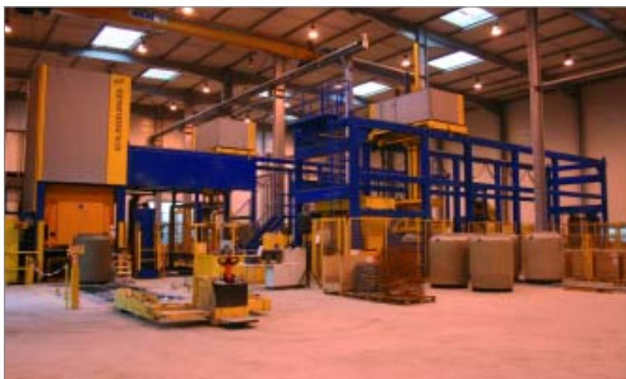
На фирме Plattard в Villefranche, Франция, недавно была введена в эксплуатацию новая автоматизированная установка Exact для производства различных шахтных конструктивных элементов (колец, конусов)
