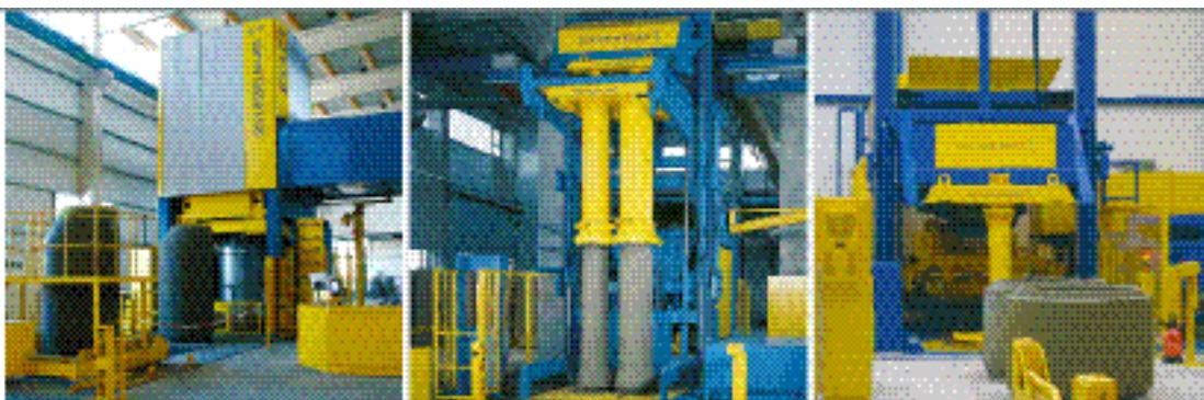
Установки для производства труб, колодцев и специальных изделий
