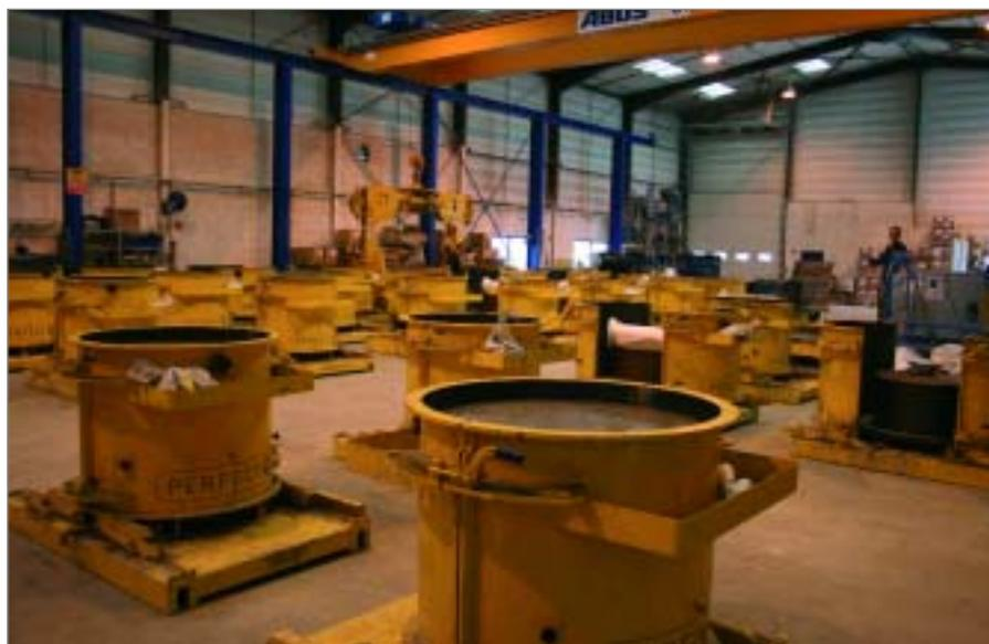
Готовые заготовки укладываются в подготовленные для колец с днищем формы
