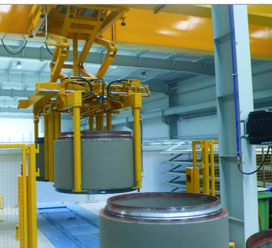
Wysokowydajny, precyzyjny i bezpieczny transport za pomocą automatycznego manipulatora TRANSEXACT
