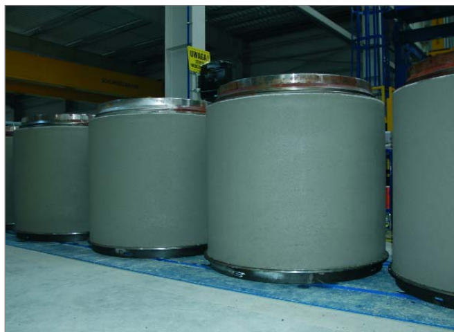
Krąg betonowy wykonany z zastosowaniem pierścieni górnych i dolnych celem zapewnienia najwyższej precyzji i stabilności studni
