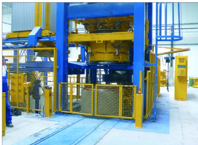
EXACT 1500 podczas pracy – w pełni zautomatyzowana produkcja kręgów betonowych z pierścieniami górnymi i dolnymi
