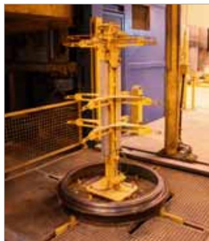
Prima della produzione degli anelli per i pozzetti vengono posizionati automaticamente il fondello, l'anello di armatura, nonché le boccole di sollevamento ed eventuali gradini.
