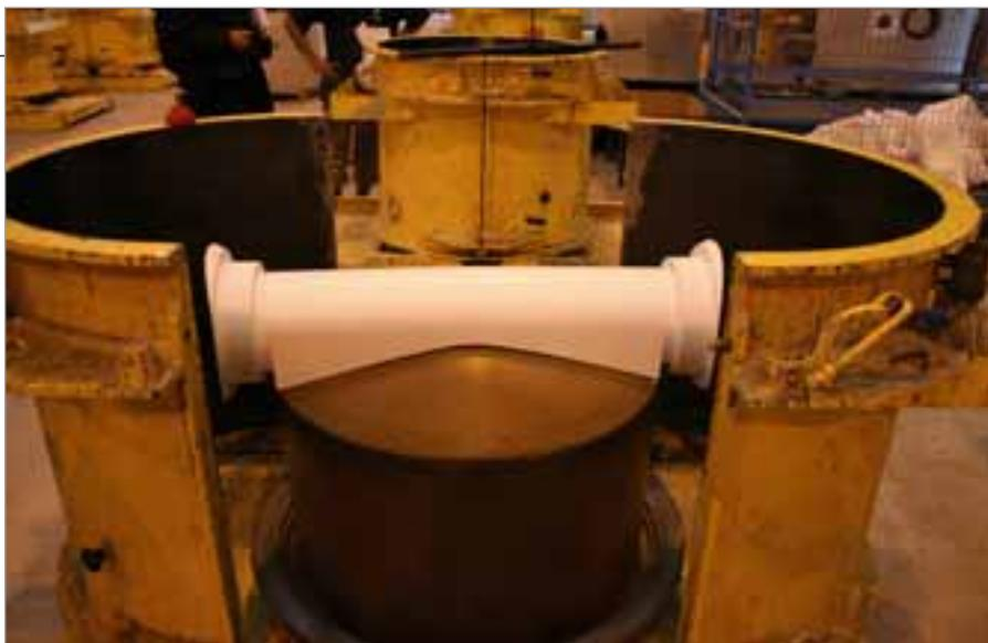
I pezzi formati finiti vengono messi nelle forme preparate per i fondi per pozzetti
