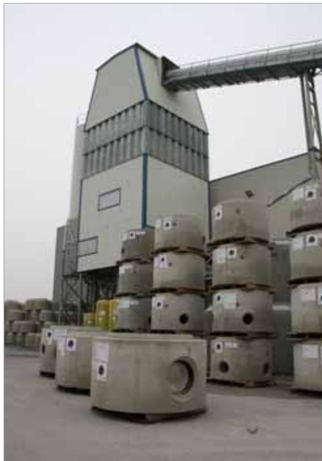
*Presso Plattard ogni capannone è dotato di un proprio impianto di betonaggio al fine di consentire un lavoro autonomo*
