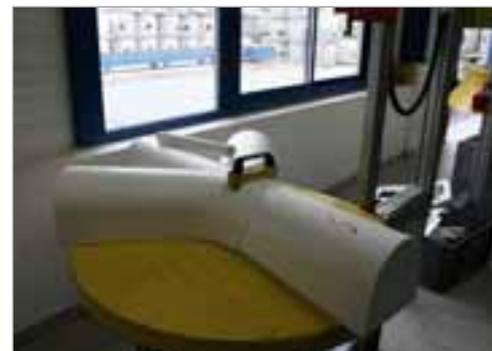
*Nella preparazione per la produzione dei fondi per pozzetti, i pezzi sagomati di polistirolo vengono tagliati a misura per mezzo del filo a caldo, in modo che tutte le curvature combacino perfettamente quando vengono assemblati i singoli pezzi.*
