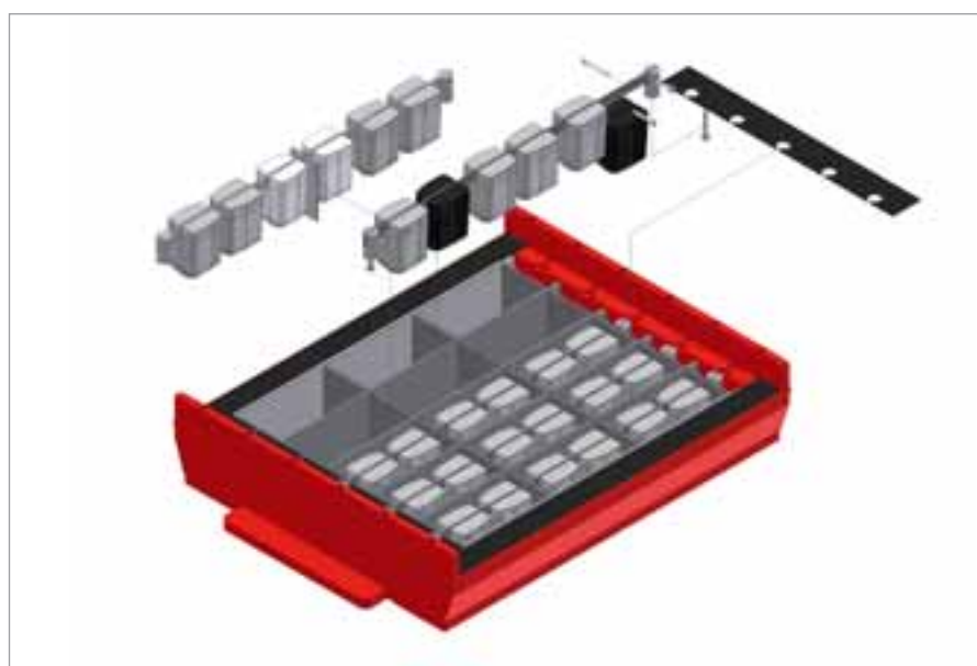
Tecnologia ITG sull'utensile sagomato per blocchi cavi con componenti sostituibili singolarmente
