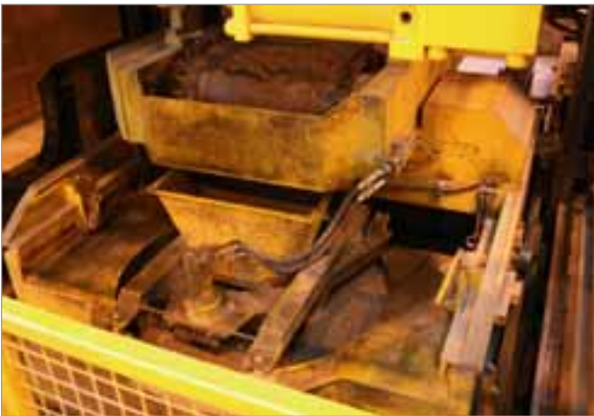
Le béton est acheminé vers la machine de production au moyen d'un convoyeur à bande
