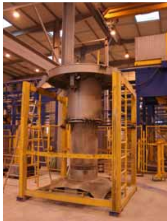
Pour un changement de moules la préparation du nouvel équipement s'effectue au niveau du sol, dans une cassette spéciale.
