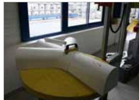
Lors de la phase de préparation à la production de fonds de regard les matrices polystyrène sont découpées au moyen d'un fil chauffant de manière à ce que les différentes pièces du «puzzle» s'adaptent parfaitement les unes aux autres.
