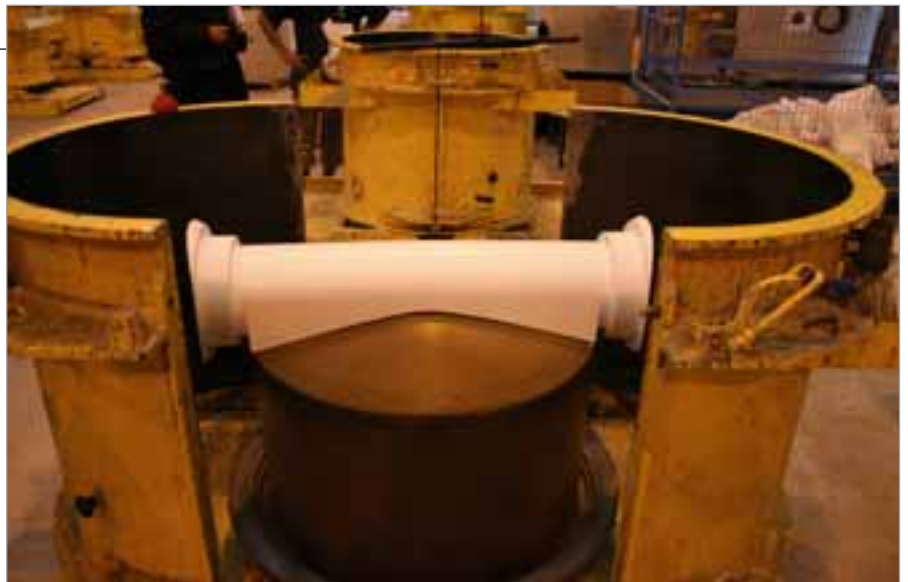
Les cunettes polystyrène sont placées dans les moules de fonds de regard
