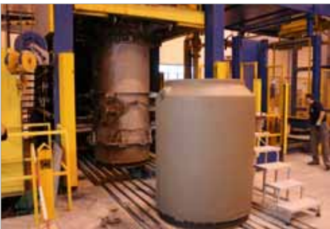
Les éléments de regards sont démoulés immédiatement après la production.
