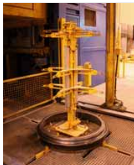
Introduction automatique, avant la production, de l'embase, de l'armature, des ancras de transport et si besoin est des échelons
