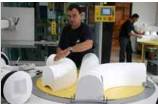
Lors de la phase de préparation à la production de fonds de regard les matrices polystyrène sont découpées au moyen d'un fil chauffant de manière à ce que les différentes pièces du «puzzle» s'adaptent parfaitement les unes aux autres.
