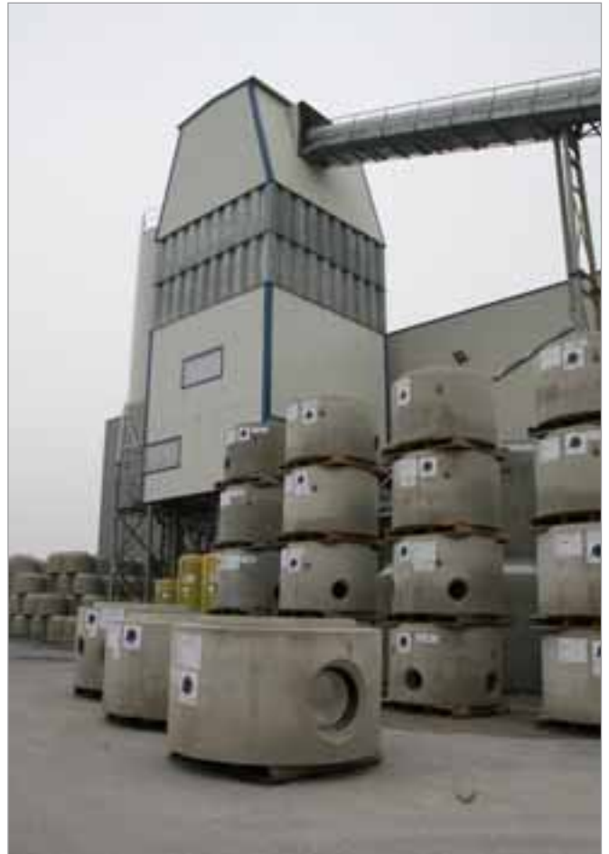
Chez Plattard chaque hall de production dispose de sa propre centrale à béton, ce qui leur permet de fonctionner en autarcie
