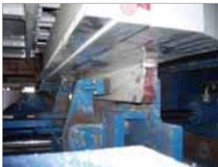
Montage du moule ITG dans la machine de fabrication de blocs en béton
