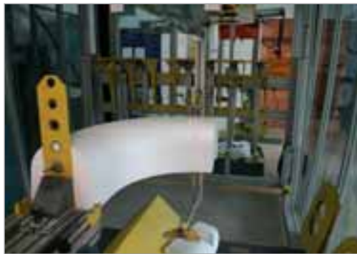
Bei der Vorbereitung zur Produktion der Schachtunterteile werden mittels Heißdraht die Formstücke aus Styropor zurechtgeschnitten, so dass sich alle Krümmungen perfekt aneinanderschmiegen, wenn die Einzelteile zusammengesetzt werden.
