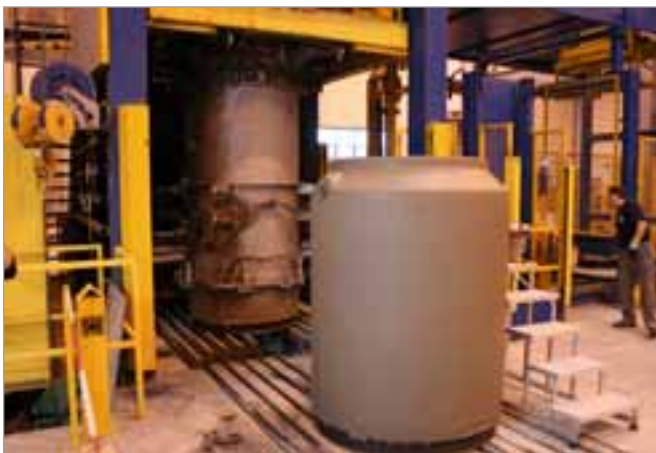
Sofort nach der Produktion werden die Schachtbauteile entschalt.
