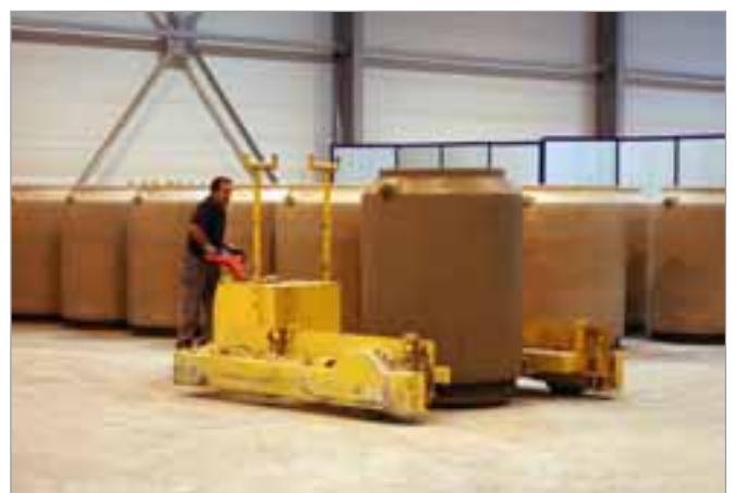
Ein Abfahrwagen bringt die Schachtbauteile zum Aushärtebereich...
