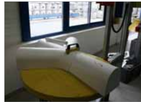
Bei der Vorbereitung zur Produktion der Schachtunterteile werden mittels Heißdraht die Formstücke aus Styropor zurechtgeschnitten, so dass sich alle Krümmungen perfekt aneinanderschmiegen, wenn die Einzelteile zusammengesetzt werden.
