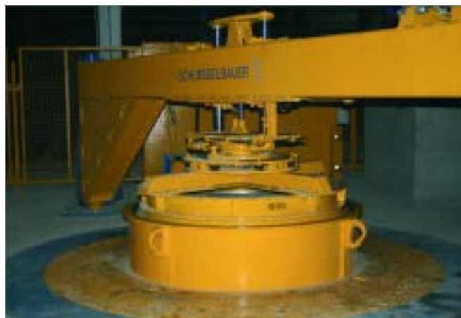
Каждый пост снабжен отдельным модулем прессования – сейчас на ваших глазах происходит конечное формование бетонной трубы d=600 мм.
