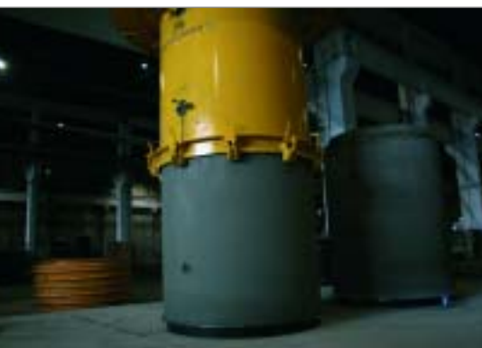
Извлечение заполненной формы из формочной станции и транспортировка на пост распалубки.
