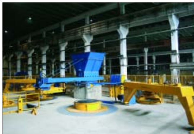
Установка EXACT XL: между двумя постами по производству труб и колодцев расположены бункер для бетонной смеси с двумя системами загрузки и панель управления.
