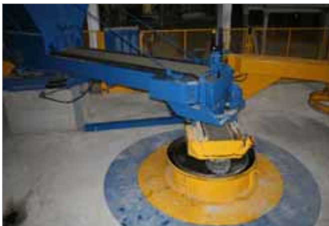
Il riempimento di calcestruzzo si realizza tramite due nastri mobili d'alimentazione con posizionamento preciso secondo il prefabbricato per ottimizzare il tempo di produzione.
