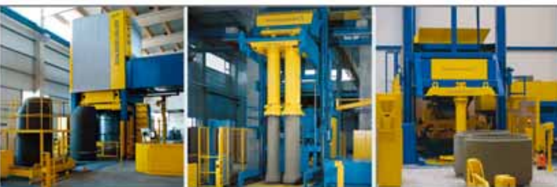
Vista generale dell'impianto EXACT XL: Fra le due stazioni di produzione per tubi e pozzetti si trova il silo di calcestruzzo insieme con i nastri di allevamento come anche il quadro di comando.
