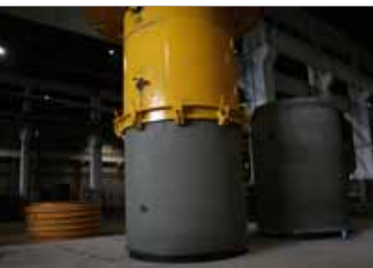
Estrazione di un molde riempito dalla stazione di produzione e trasporto per disarmare il tubo.
