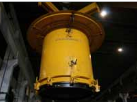
La gamma di prefabbricati producibili sull'impianto EXACT XL giunge dal tubo di grandi dimensioni fino al semplice anello di pozzetto con altura 250mm.
