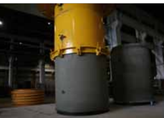
Sortie du moule plein et transport avant démoulage.
