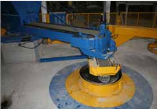
l'alimentation en béton est assurée par deux convoyeurs positionnés exactement et adaptés au produit à fabriquer – la durée de remplissage est optimisée.
