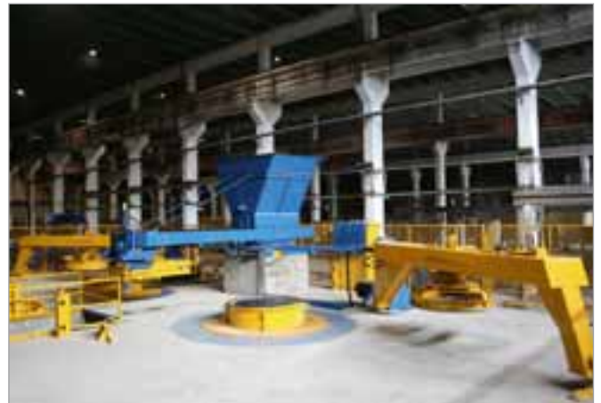
Die Produktionsanlage Exact XL im Überblick: Zwischen den beiden Stationen für Rohr- und Schachtringfertigung sind der Betonbehälter samt Beschickungsbänder sowie die Bedienstation angeordnet.
