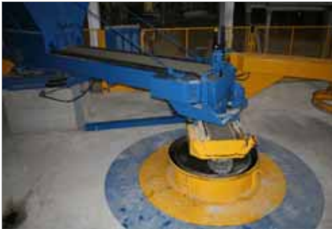
Über zwei mehrfach verfahrbare Beschickungsbänder wird die Betoneinbringung exakt positioniert auf das zu fertigende Produkt abgestimmt und so die Fülldauer optimiert.
