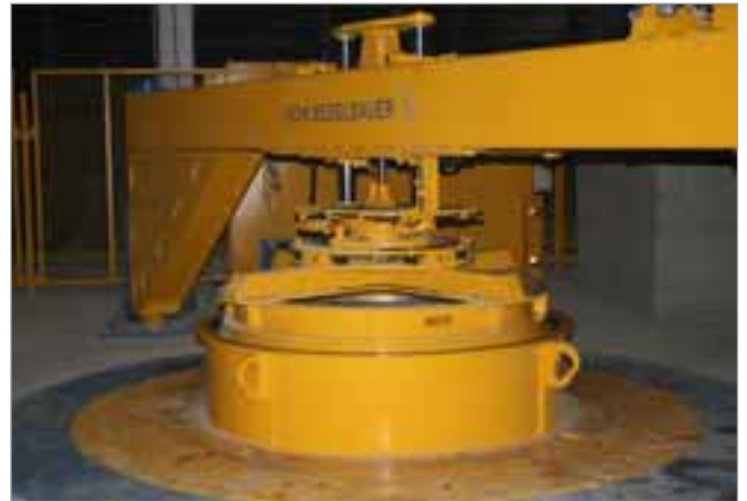
Jede Produktions-Station verfügt über eine eigenständige Press-Einheit – hier im Einsatz für die endgültige Formgebung bei einem Betonrohr DN1600.
