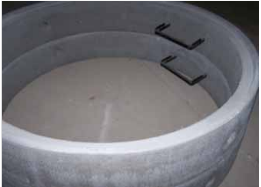
Die Bandbreite der auf der Exact XL herstellbaren Produkte reicht vom großformatigen Betonrohr bis zum einfachen Schachtring mit Bauhöhe 250 mm.
