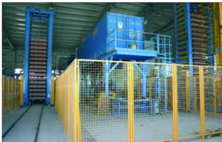
В сорокафутовом контейнере – на фирме Masa он называется Powerainer – размещается вся техника управления.
