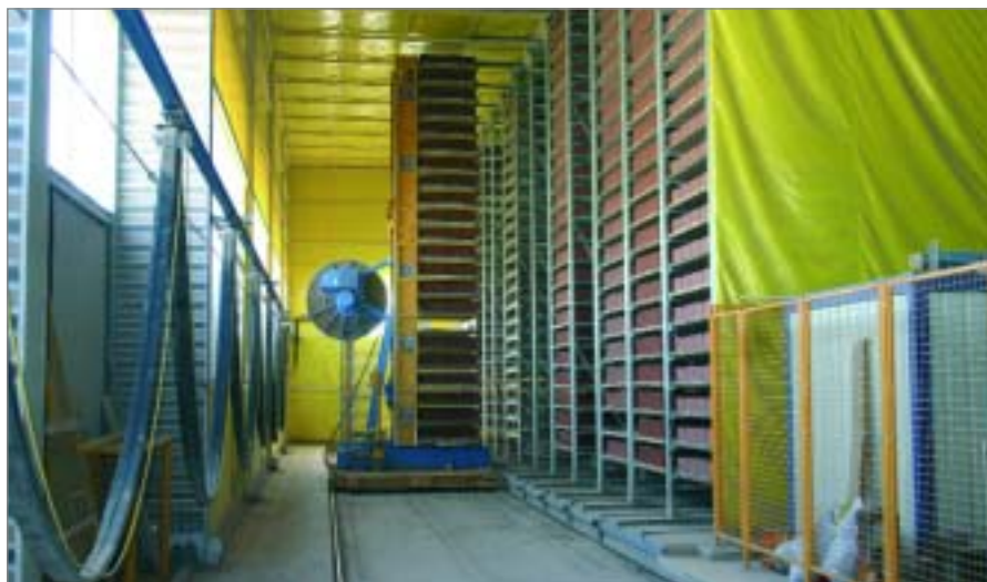
Передвижная платформа-автомат загружает и разгружает стеллаж для сушки продукции.
