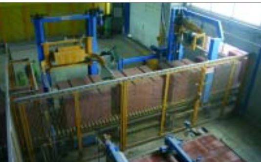
Обвязка пакетов осуществляется с помощью машины фирмы Ridder.
