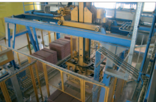
Nella sezione di impacchettatura, gli strati di blocchi vengono raggruppati in pacchetti
