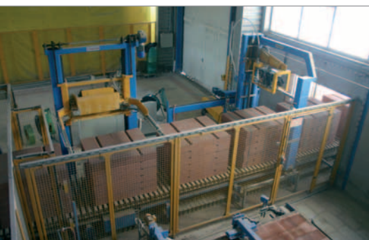
La reggiatura dei pacchetti viene effettuata dalla reggiatrice della ditta Ridder
