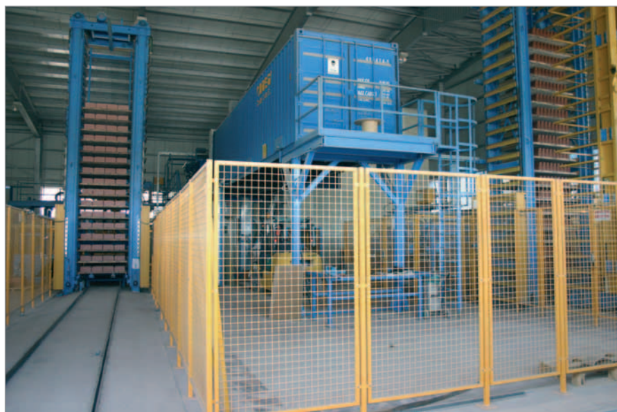
Il container da 40' - chiamato da Masa: Powertainer - contiene tutti i comandi preinstallati
