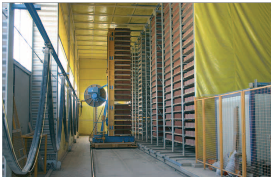
La piattaforma mobile completamente automatica carica e scarica il sistema di scaffalature
