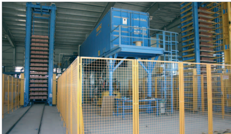
Le conteneur 40" – synonyme chez Masa de Powertainer – contient toutes les commandes pré-installées.
