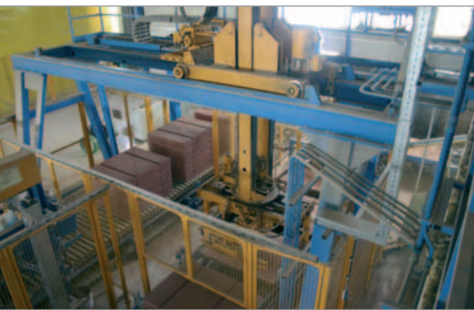
L'installation de mise en paquets regroupe les couches de blocs et les assemble en paquets
