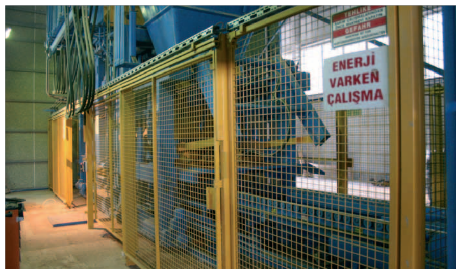
La machine à blocs de béton chez Özkul est clôturée conformément aux prescriptions de sécurité
