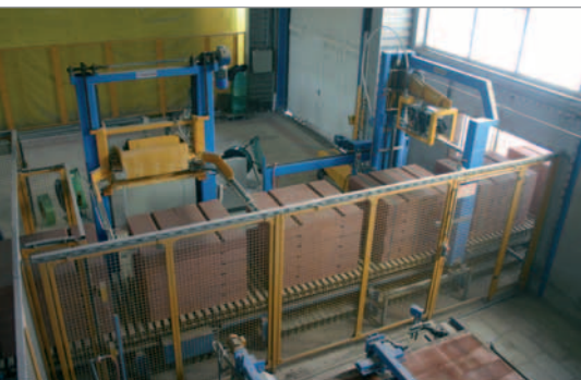
Le cerclage des paquets de blocs est réalisé par une installation de cerclage de la société Ridder
