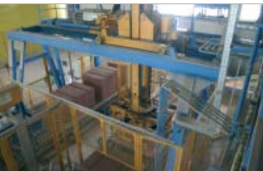
An der Paketierung werden die Steinlagen zu Steinpaketen zusammengesetzt.
