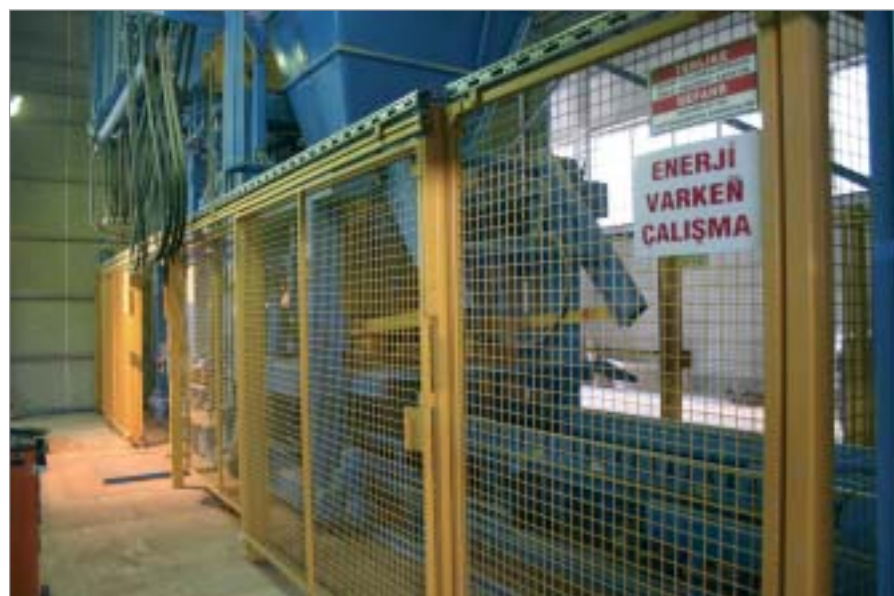
Die Steinformmaschine bei Özkul ist entsprechend den Sicherheitsvorschriften eingezäunt.
