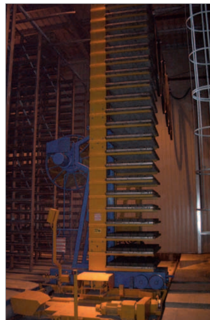
La piattaforma mobile rotante completamente automatica carica e scarica il sistema di scaffalature di HS, realizzato come sistema chiuso con un impianto di riciclo dell'aria.
