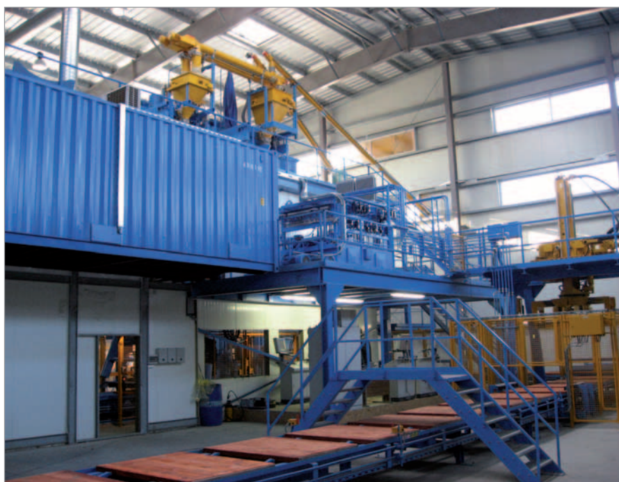
L'impianto di miscelazione e dosaggio è posizionato subito sopra la blocchiera.
