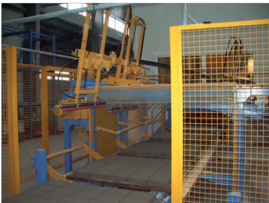
Les blocs de béton produits par la machine à blocs de béton sont acheminés vers l'élévateur par un dispositif de descente et un convoyeur de levage.
