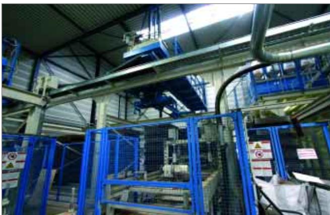
Уложенные ярусами поддоны доставляются с помощью крана обратно к машине для изготовления бетонных камней.
