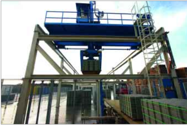
Во внешней зоне завода установлен кран для буферного хранения пакетов.
