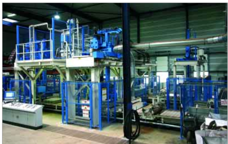
За исключением зажимов, все механизмы приводятся в движение с помощью серводвигателей.
