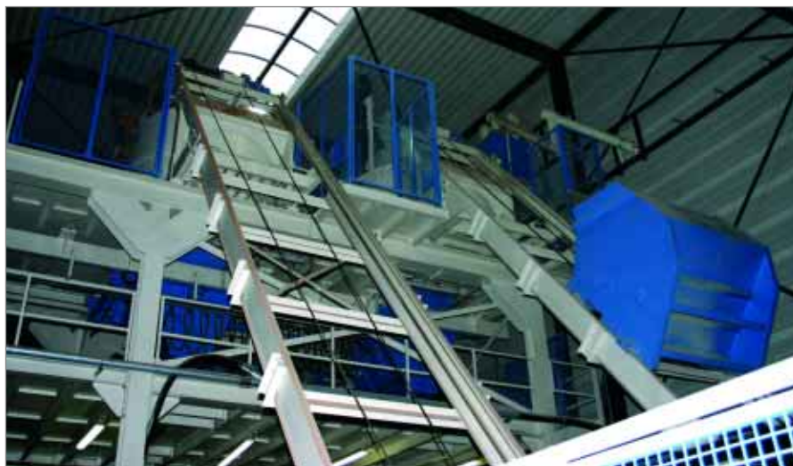
Два высокопроизводительных смесителя HM 2000/3000 и HM 1000/1500 фирмы Masa выполняют всю работу.
