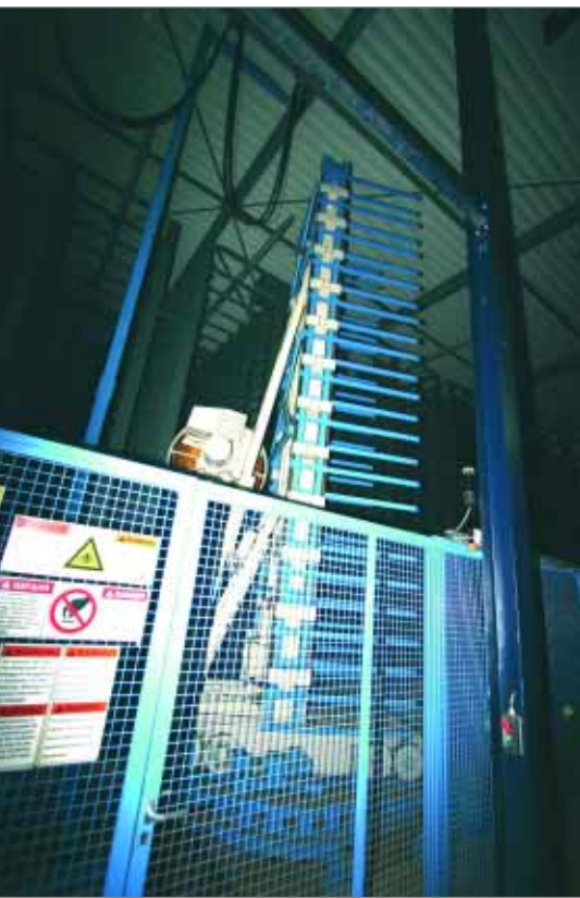
Проходя подъёмный лифт, поворотную платформу, стеллаж выдержки и опускной лифт, готовые изделия попадают на сухой участок.
