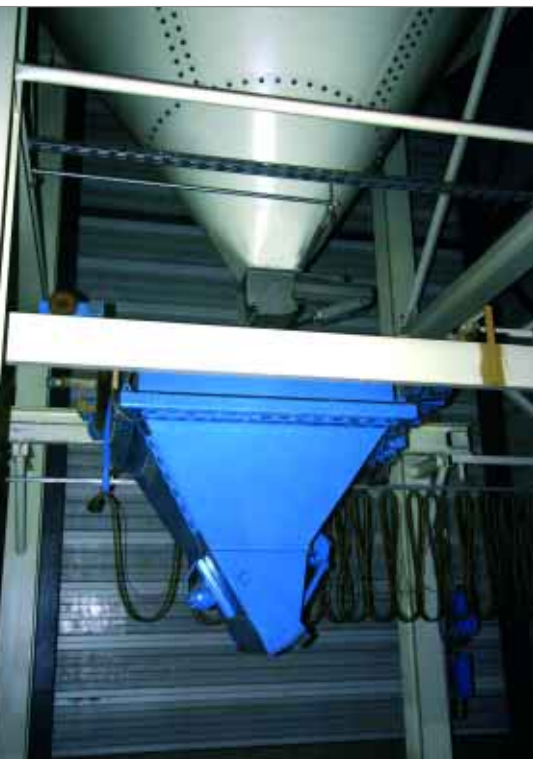
Через пневматически управляемые заслонки дозатора и два весовых дозатора песчаные смеси загружаются прямо в подъёмники смесителей.
