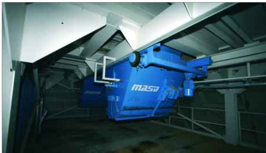
Вместимость двойного ковшового транспортёра составляет 6 400 литров
