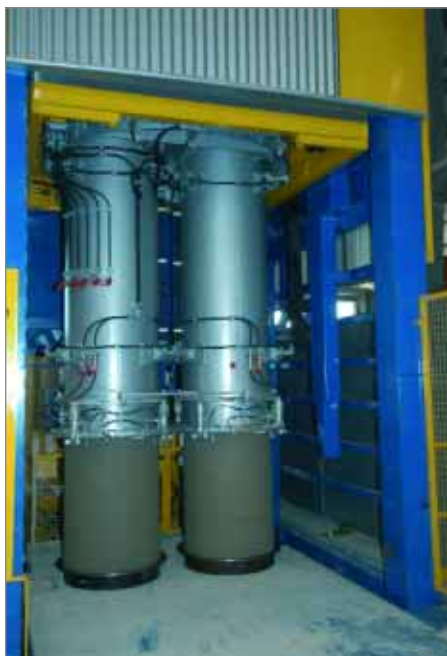
Экономичность посредством одновременного изготовления 2-х труб диаметром до 600 мм/24'
