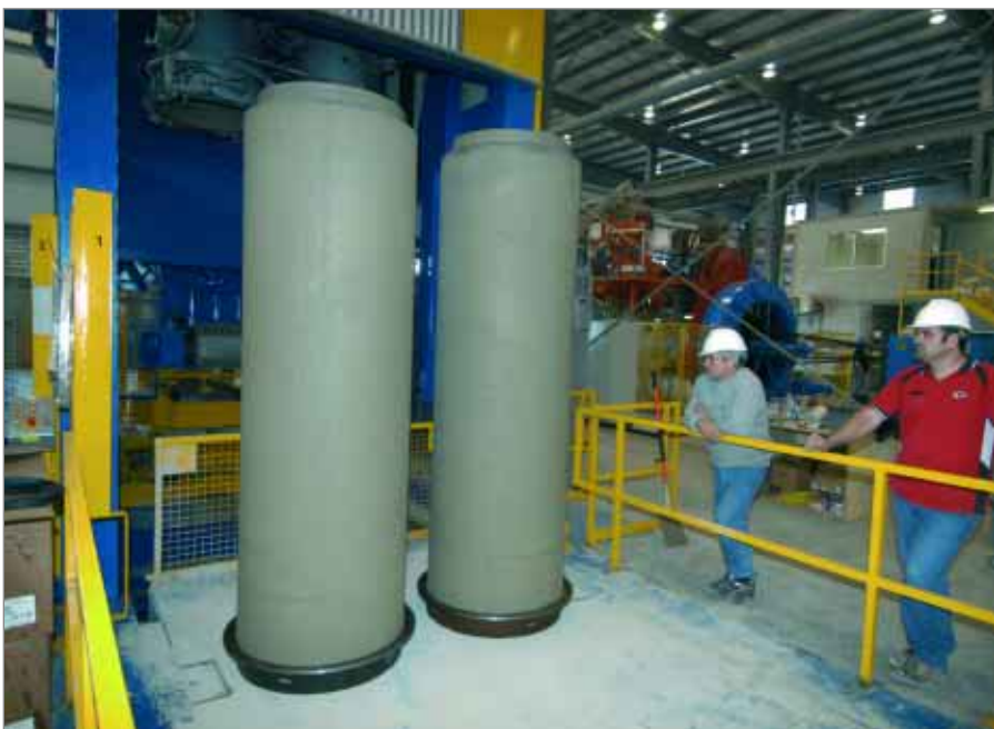
Экономичность посредством одновременного изготовления 2-х труб диаметром до 600 мм/24'
