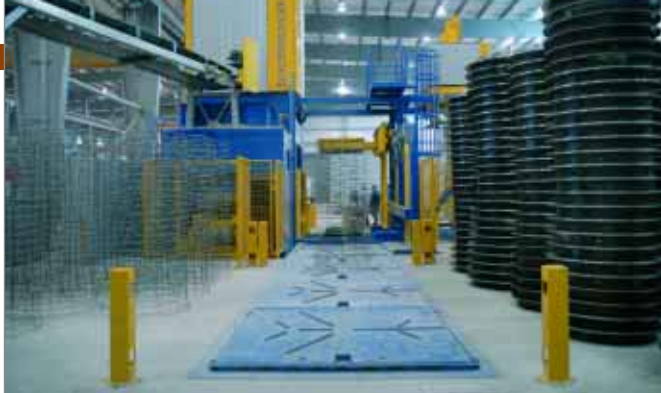
Автоматизация хандлинга поддонов и подачи арматурных каркасов
