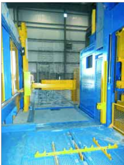
Автоматизация хандлинга поддонов и подачи арматурных каркасов
