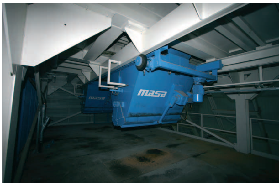
L'installation mobile à double benne présente une capacité totale de transport de 6.400 l
