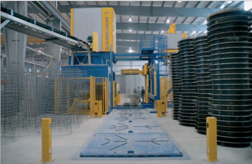
Automatisation de la maintenance des rondelles et de l'introduction des cages d'armature
