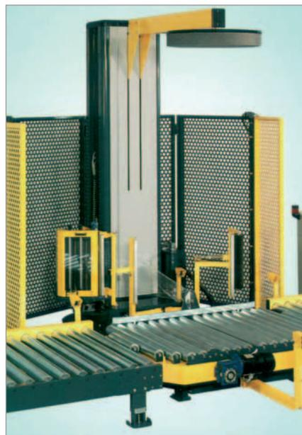
*L'installation de houssage par étirement à plateau tournant entièrement automatique «WS 46» constitue une machine «all round» performante pour l'industrie des matériaux de construction.*
