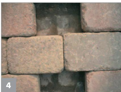
Echantillons de produits réalisés avec (à g.) et sans (à dr.) système de durcissement CDS
