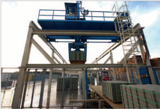
Im Außenbereich des Werkes wurde ein Paketpufferkran installiert
