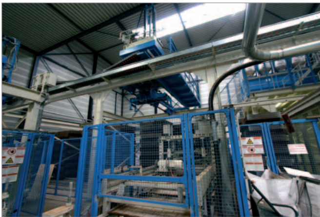
Die Palettenstapel werden über einen Blechstapelkran wieder der Steinfertigungsanlage zugeführt
