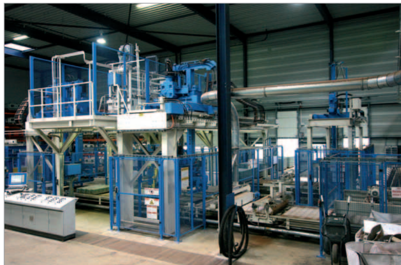
Bis auf die Klammer werden alle Bewegungen mittels Servo-Motoren durchgeführt
