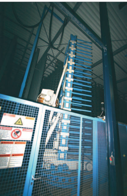
Über Hubgerüst, Schiebebühne, Trockenregal und Senkgerüst werden die Produkte auf die Trockenseite gebracht
