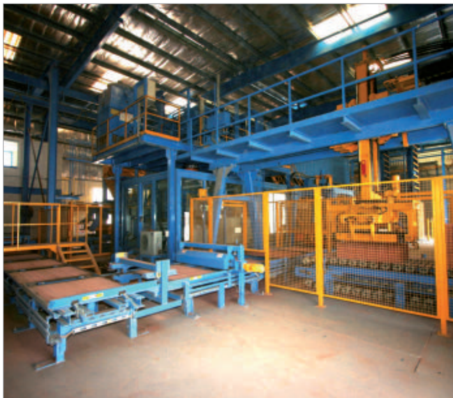
Trasporto trasversale delle lamiere e imballaggio con trasportatore a piastre
