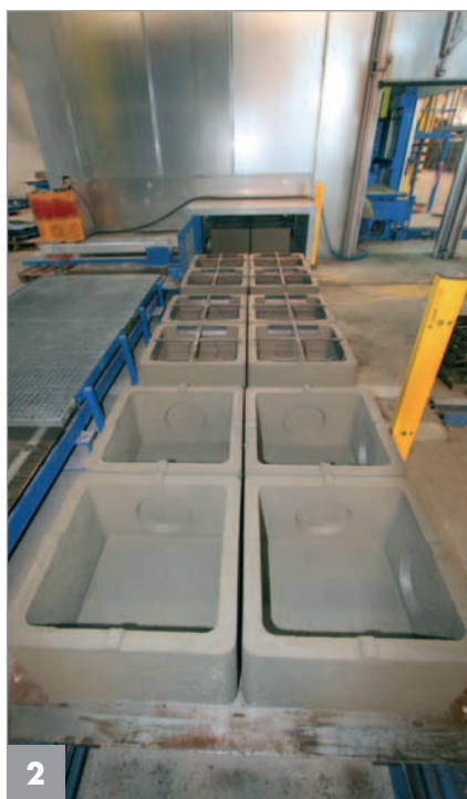
2 Les produits présentent des parois fines et des cotes précises
