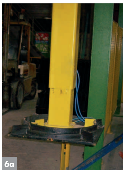
Mise en place automatique d'un cadre en fonte dans le moule
