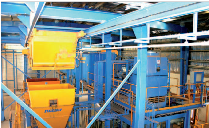
Steinfertigungsmaschine und Kübelbahn bei Bucamac, im Hintergrund sieht man den „Cooling Tower“ auf der Hydraulikplattform
