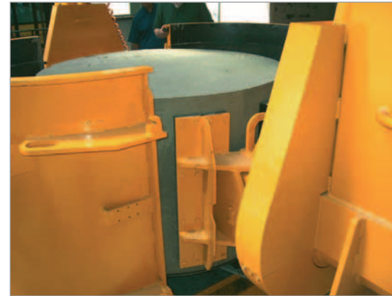
Das fertiggestellte Schachtunterteil wird entschlüsselt. Jean-Claude Pitois: „Perfect respecte l’identité du béton, on reste dans le même métier.“ „Mit Perfect bewegen wir uns in unserem angestammten Metier und fördern die Akzeptanz von Beton.“
