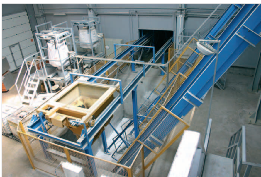
La bilancia di carico pesa gli inerti e riempie gli elevatori del miscelatore
