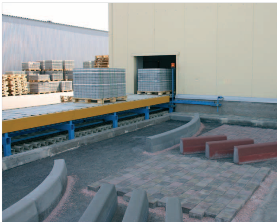
I pacchetti di blocchi pronti vengono portati all'esterno da impilatori fino al magazzino
