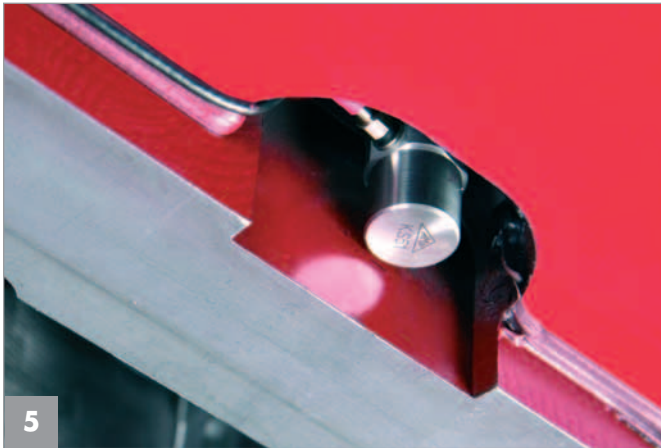
Kobra »Oscillate« – plate-forme livrée en option pour le montage d'accéléromètres
