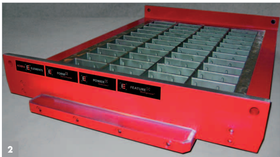
Technologie de moule moderne. Le moule Kobra »Moduline2« équipé d'un sous-ensemble à bride vissé.
