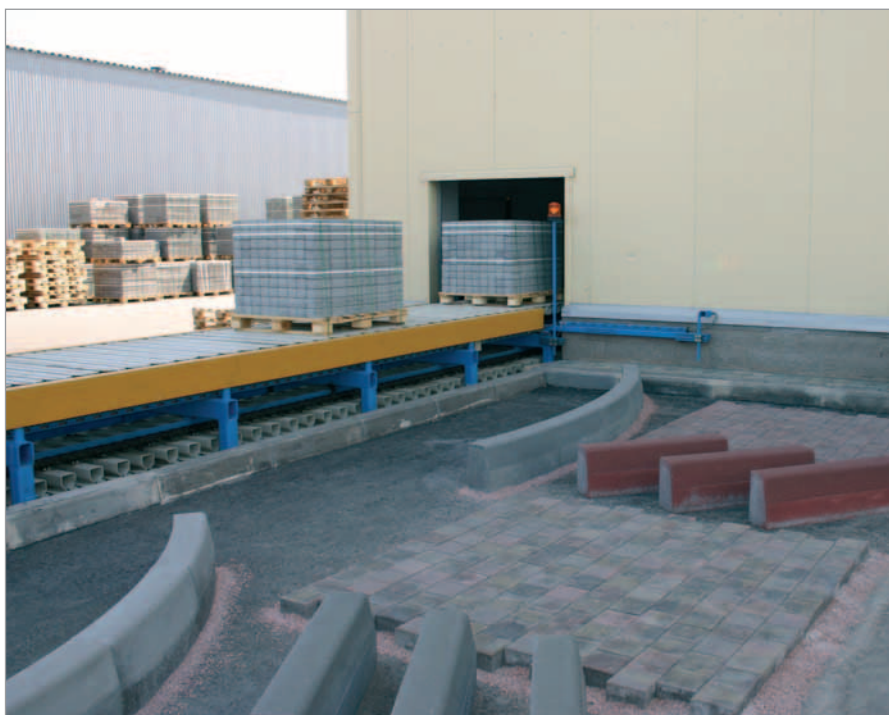
Les paquets de blocs terminés sont acheminés vers la zone extérieure par des empileurs, jusqu'à l'emplacement de stockage
