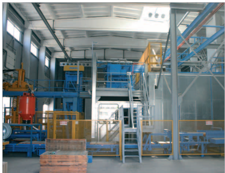
Pour des raisons d'insonorisation, la presse à blocs de béton Record 9001 VB est entièrement isolée.
