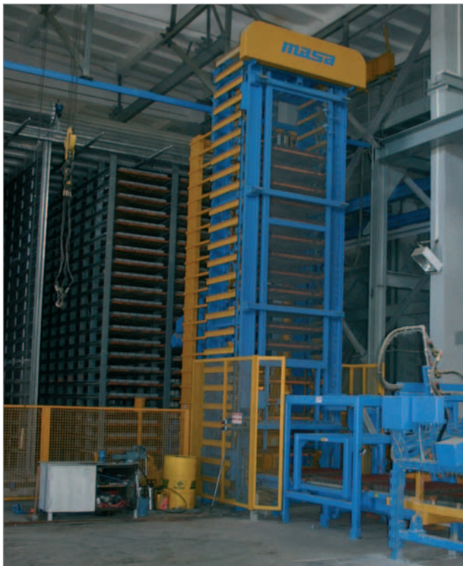
Die Regalanlage von H&S wurde als geschlossenes System mit einer Luftumwälzanlage ausgeführt
