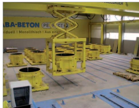
Ein Blick in die Produktion der neuen „Perfect“-Schachtunterteile. Jeder Schacht wird mit einer individuellen Gerinneausformung hergestellt, wobei mittels einer speziellen Heizdraht-Schneidetechnik CNC-gesteuert, berührungsfrei und absolut genau die erforderlichen Passstücke konfiguriert werden. Im Fertigteilwerk kommt dabei ein automatisches Handling-, Krantransport- und Lagersystem für die Schachtunterteil-Gießformen zum Einsatz.
