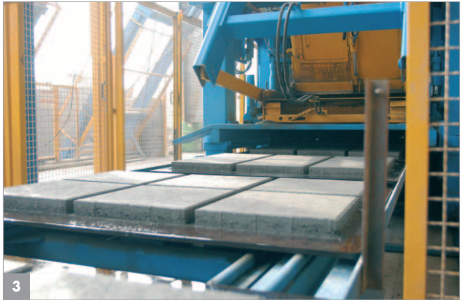
Produktion von Betonplatten auf der Masa 9001 XL
