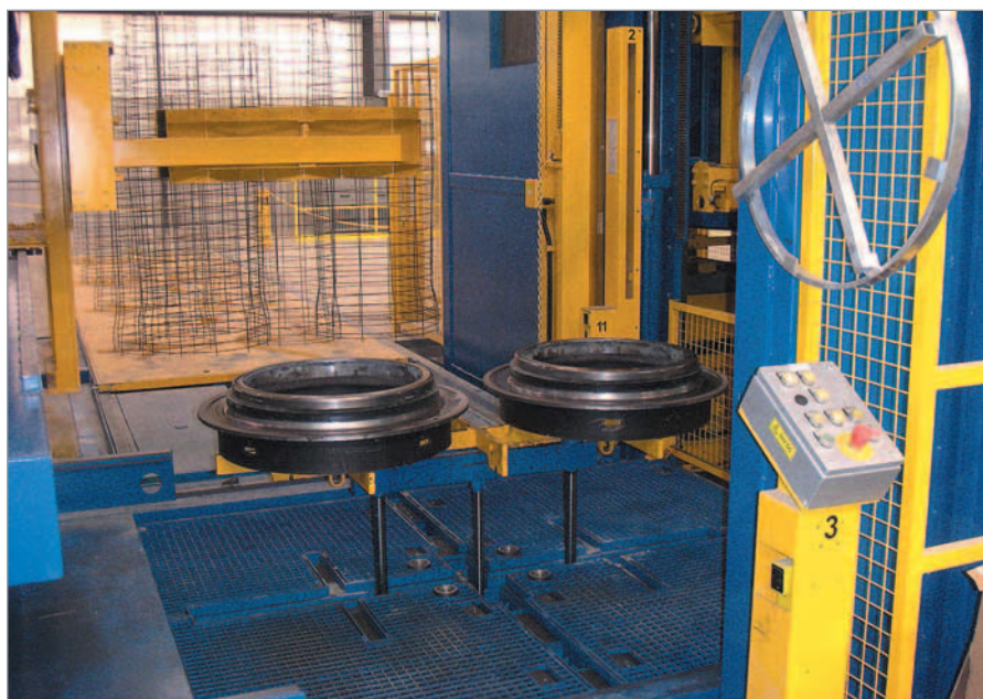
Imbocchi femmina con la nuova guarnizione integrata
