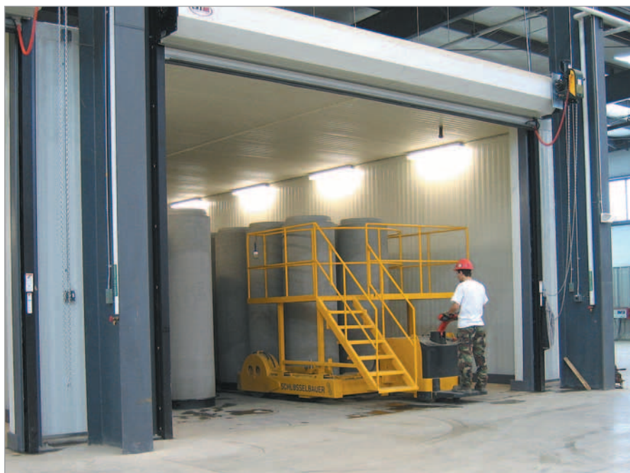
Camere di stagionatura per un indurimento ottimale dei tubi
