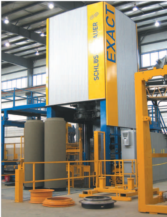
Doppelfertigung der neuen Rohre DN 600
