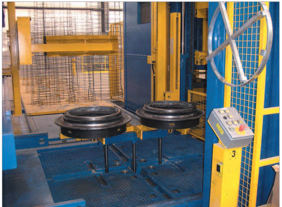
Untermuffen mit der neuen integrierten Dichtung
