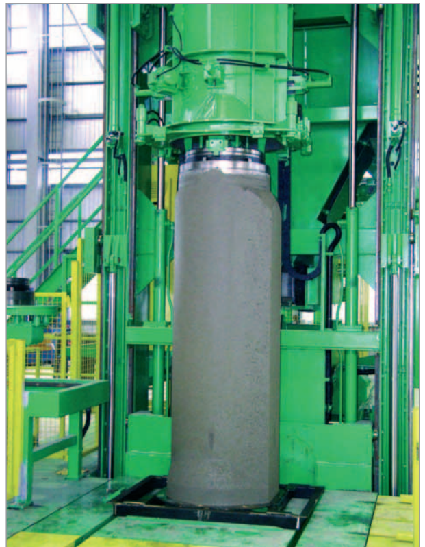
Tube a base piatta appena disarmato DN 600x2500
