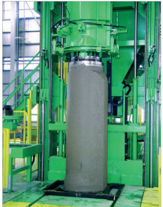
*Tube à pied intégré DN 600x2500 fraîchement décoffrée*
