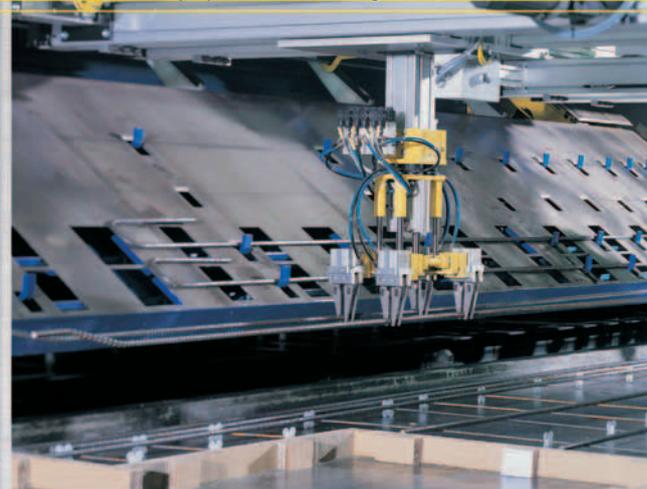
Lignes de dressage à rotor et de découpage - Robots pour poser les aciers d'armature -
