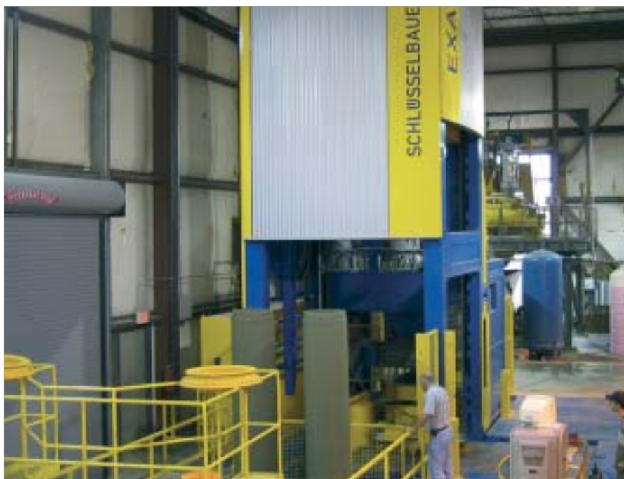
EXACT 2500-Maschine für die Produktion von Rohren und Einstiegsluken
