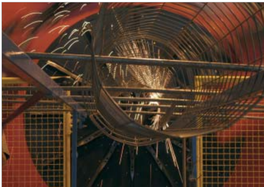
Die Korbschweißmaschine von ZÜBLIN
